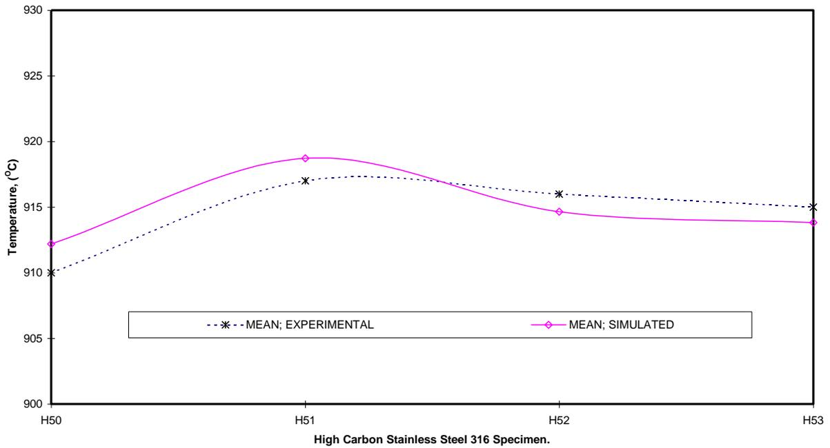
Fig. 4: VALIDATION OF SIMULATED RESULTS USING MEAN ROLLING TEMPERATURE ESTIMATION
