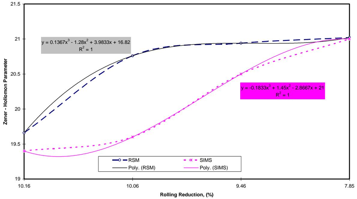
FIG.3: DEPENDENCE OF ZENER - HOLLOMON PARAMETER ON ROLLING REDUCTION BASED ON DIFFERENT ROLLING THEORIES
